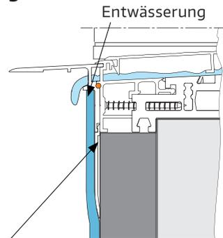
Kante über gesamte Länge mit Dichtmasse,
