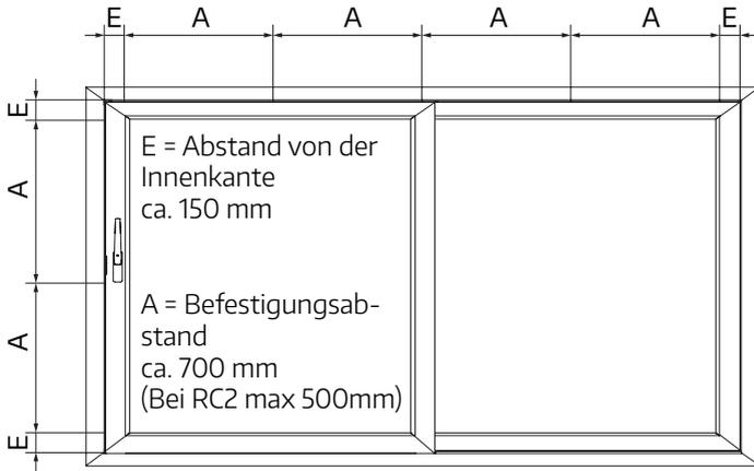
Die Falzlufte zwischen Flügel und Rahmen von 15 mm ( $\pm 1$  mm) ist zu beachten. Die Fuge zwischen Mauerwerk und Rahmen darf maximal 10 - 15 mm betragen.
